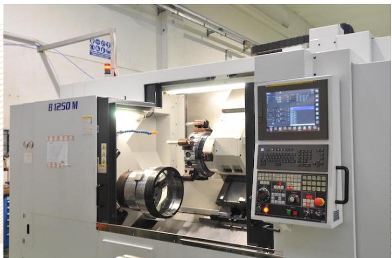
scorrimento per carrelli industriali e cuscinetti combinati speciali. Un'altra caratteristica principale di questa macchina è la possibilità di integrare un braccio robotico nel sistema FMS (Flexible Manufacturing System). Questo investimento fa parte del progetto Industria 4.0, in linea con la visione strategica di TTS.
